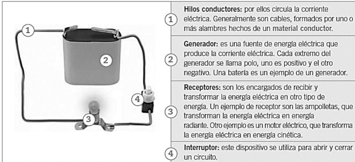
Los elementos de un circuito se combinan de diferentes maneras. Estos deben formar una trayectoria cerrada para que la corriente eléctrica pueda circular.
