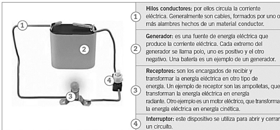
Los elementos de un circuito se combinan de diferentes maneras. Estos deben formar una trayectoria cerrada para que la corriente eléctrica pueda circular.
